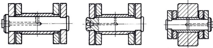
Graisseurs avec conduits de graissage
