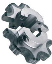
Une autre solution dans ce cas serait la mise en place de pignons de manutention avec double pas. Ils sont idéaux pour gagner de la place et durent 2 fois plus longtemps que les pignons classiques : lorsque les premières dents sont usées, il suffit de décaler la chaîne d'un pas sur le pignon.
