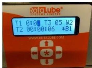
Pour s'assurer que la chaîne complète est correctement lubrifiée, nous recommandons un cycle complet de la chaîne de transport +5 % pour le temps d'activation.
