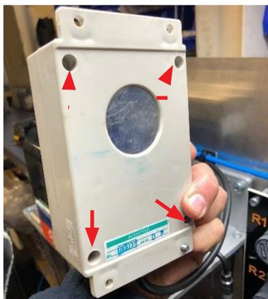
À l'aide d'un tournevis, retirez les quatre vis à l'arrière de l'unité de commande.
