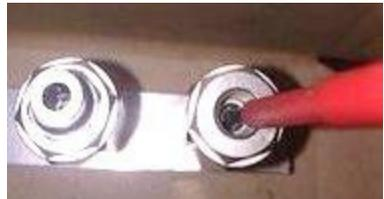
L'absence d'écoulement d'huile peut signifier que la vis de réglage a été serrée à fond et empêche l'écoulement d'huile pendant un cycle de pompage.
