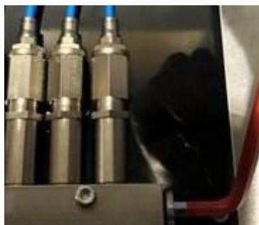
Une fois que le réservoir a été rempli avec l'huile recommandée et que le système a été purgé, retirez les tuyaux de 4 mm qui se trouvent sur les raccords enfichables du distributeur de mélange.
