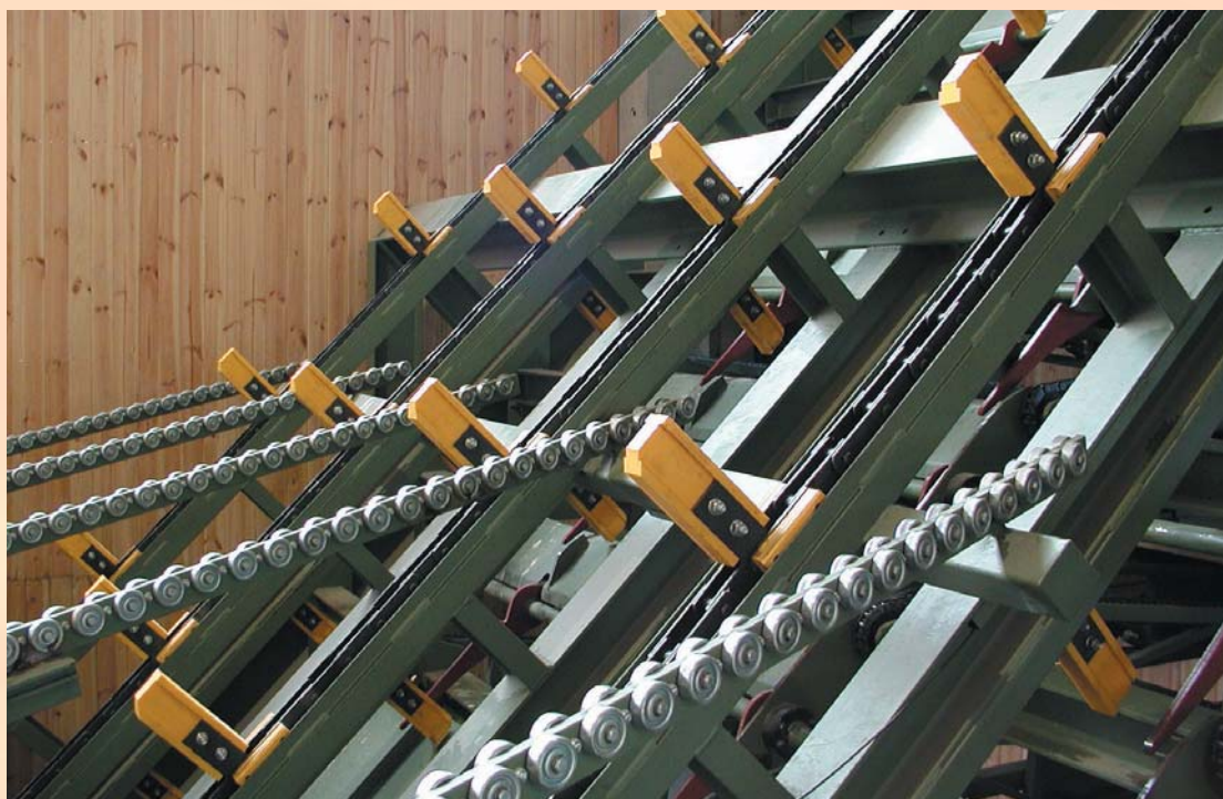
Tipo D rodillos con pestaña avec galets épaulés
