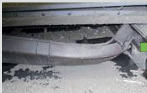
"Cuillières" excavatrices d'un transporteur de résidus de combustion
