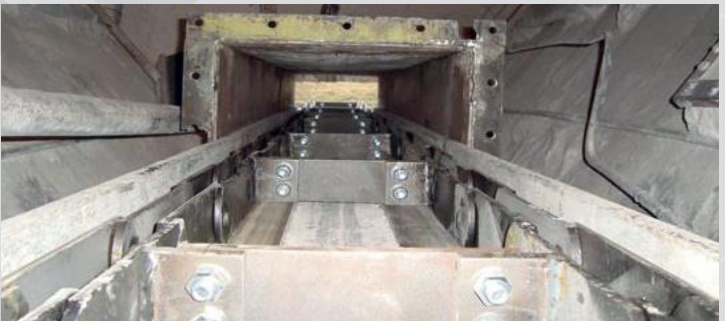
Chaîne à douilles FB optimisée pour un extracteur sous silo à chaux
